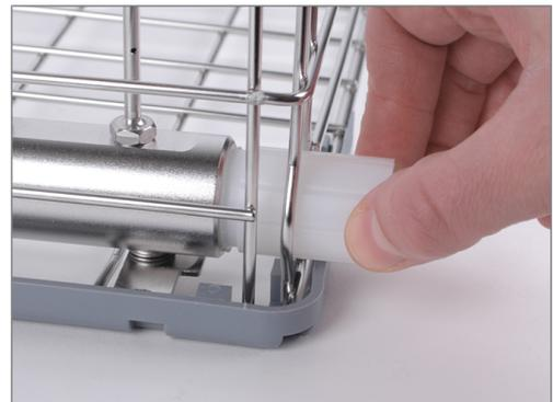
2. **Verschieben Sie niemals den Abstandshalter.** Der Abstandshalter am Zentralfilter gewährleistet den korrekten Abstand zwischen Zentralfilter und der Innenwand der Injektorschiene und blockiert in dieser Position nicht die Anschlüsse der Injektorschiene.
