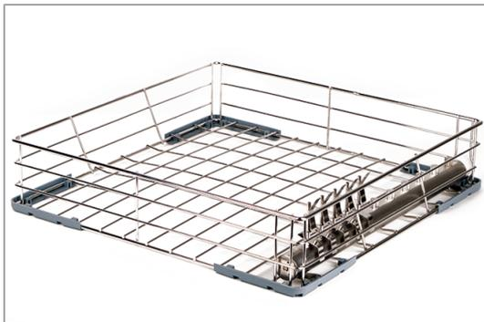
Der Basiskorb mit Injektorschiene und Zentralfilter dient zur Aufbereitung von Hohlkörperinstrumenten mit einem Innendurchmesser  $< 0,8$  mm. Die Hohlkörperinstrumente werden mittels Adapter mit der Injektorschiene verbunden. Der Einsatz weiterer Filterelemente ist nicht gestattet. Die integrierte Kontrollanzeige der Injektorschiene zeigt an, ob ein Mindestspüldruck erreicht wurde.
